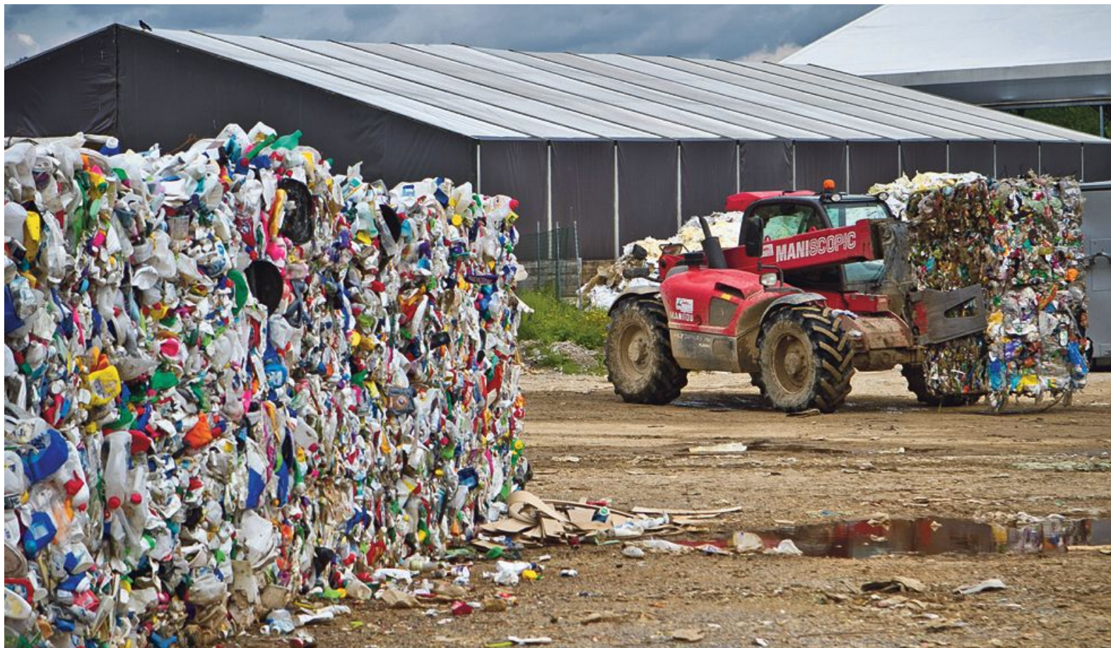
V 100-tonski stiskalnici v kocke stisnjena embalaža, zaradi česar je lahko na tovornjake naložijo precej več, kakor če bi vozili razsuti tovor.
